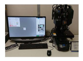
蒸着装置・自動検査装置に加え レーザー励起ブレークダウン分光法(LIBS)分析装置を導入 コート膜の異物解析や膜評価を強化しました。 従来のレーザー顕微鏡画像解析 SEM-EDX では 対応が難しかった対象物も、迅速かつ正確に解析可能となり さらなる品質向上を実現しています。
